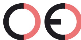
Faux marquage CE (trop éloignée)
